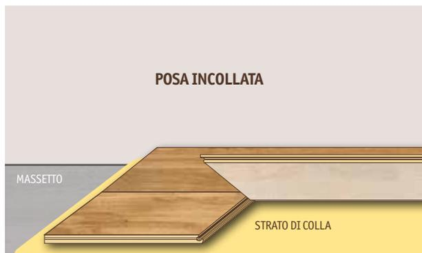
Il parquet è ancorato al cemento tramite uno strato di colla. Il risultato si percepisce principalmente camminando sopra il pavimento, con una sensazione al calpestio più solida rispetto al pavimento flottante. La posa incollata risulta più costosa, richiede più tempo per essere realizzata e il pavimento non potrà essere smontato e riutilizzato.
