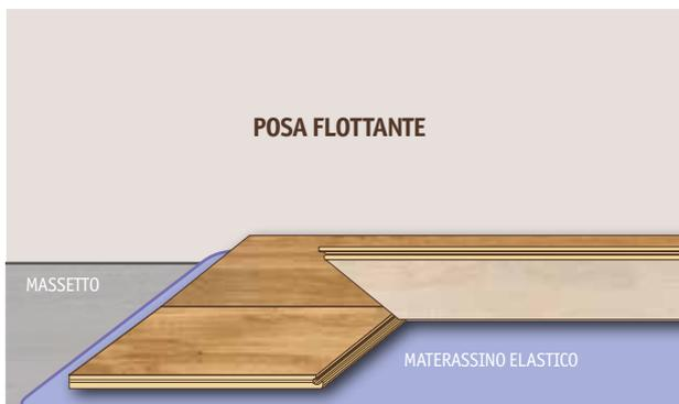
Il pavimento viene semplicemente appoggiato al sottofondo, interponendo un materassino elastico tra pavimento e sottofondo. I vantaggi della posa flottante consistono nella maggior semplicità applicativa e nella possibilità di rimuovere e riutilizzare il parquet senza danneggiare la superficie di appoggio.
